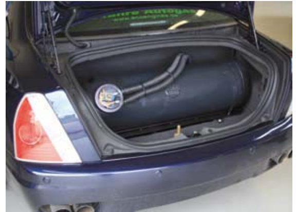
Nimm Zwei: Ein Tank in der Radmulde unter der Kofferraumabdeckung und ein weiterer Zylindertank, der bei Bedarf entfernt werden kann, sorgen für komfortable Reichweiten von fast 1300 Kilometer.
